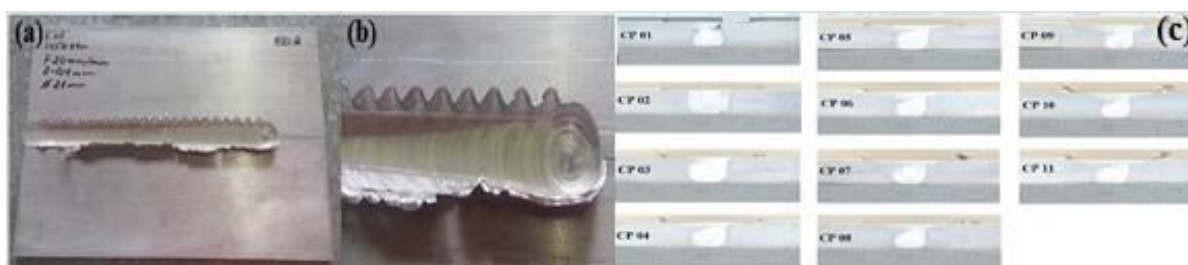
Figura 3. (a) Aspecto superficial e (b) formação excessiva de rebarba.
