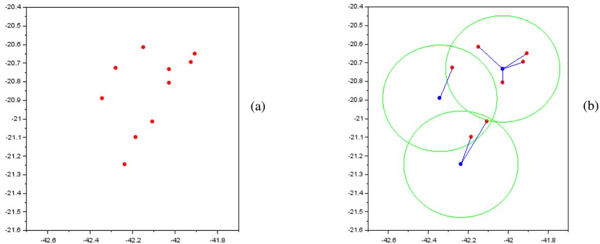
Figura 5 – (a) Gráfico da região dos pontos candidatos, e (b) três centros de facilidades definidos pelo algoritmo
